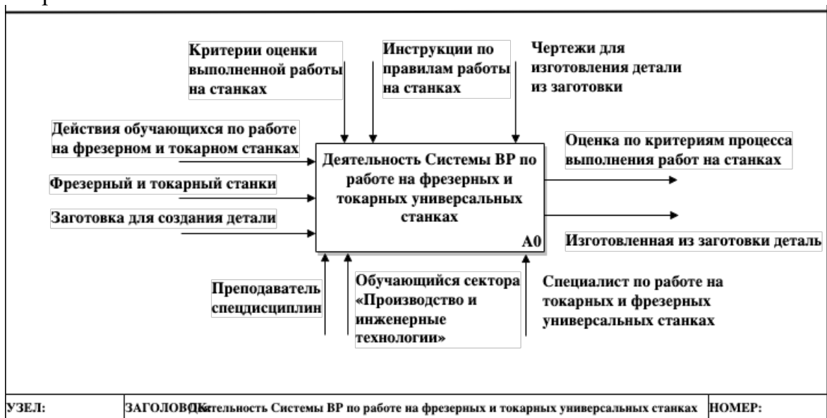
Рисунок 5. Контекстная диаграмма IDEF0 функционирования виртуальных тренажеров реальности для универсальных металлорежущих станков: фрезерных и токарных
